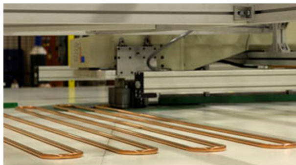
Kuva 2: Atrium Planan huipputarkka laserhitsaus.
